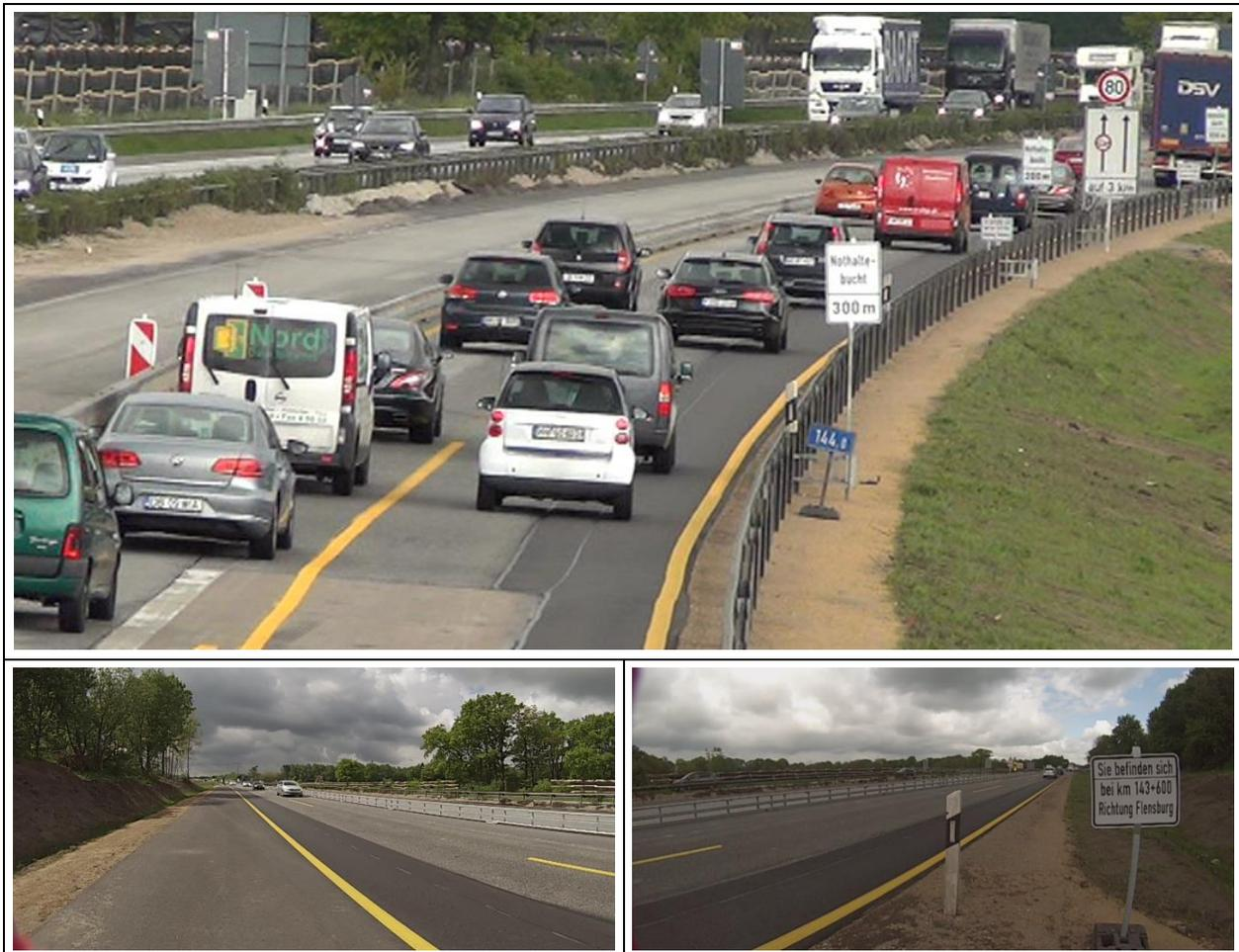
**Bild 3:** Kameraausschnitte der Videomessungen im Bereich zwischen der Rückverschwenkung und der Fahrbahnverengung (oben: Messstelle 1, direkt stromabwärts der Rückverschwenkung, unten links: Messstelle 2, stromaufwärts der Nothaltebucht, unten rechts: Messstelle 3, stromabwärts der Nothaltebucht)
